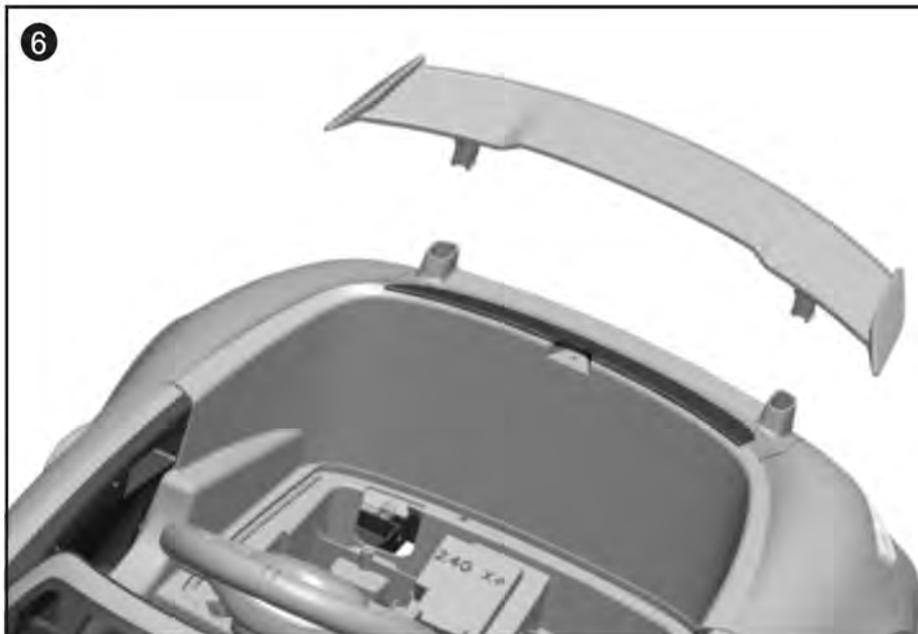
Stecken Sie den Heckspoiler in die dafür vorgesehene Öffnung am Heck und drücken ihn fest bis zum „Klick“. Versichern Sie sich, dass der Spoiler richtig eingerastet ist.
