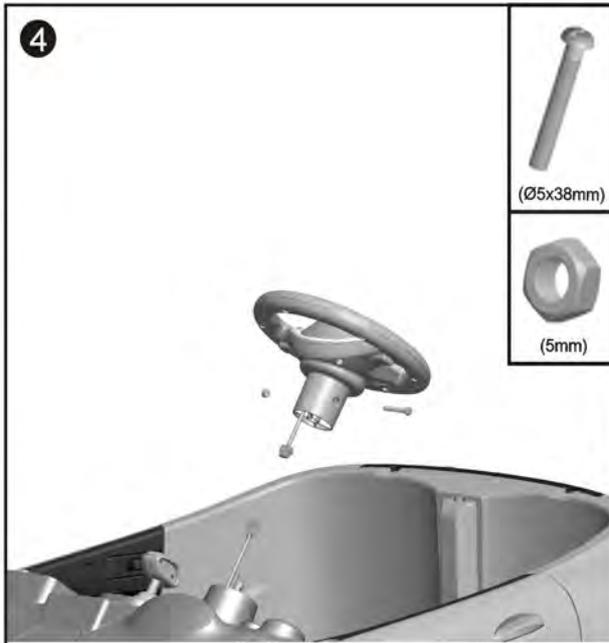
Verbinden Sie die Stecker am Lenkrad mit dem Fahrzeug. Stecken Sie das Lenkrad auf die Lenksäule. Achten Sie darauf, dass das Kabel nicht abgequetscht wird. Schrauben Sie das Lenkrad wie auf dem Bild mit Schraube und Mutter fest.
