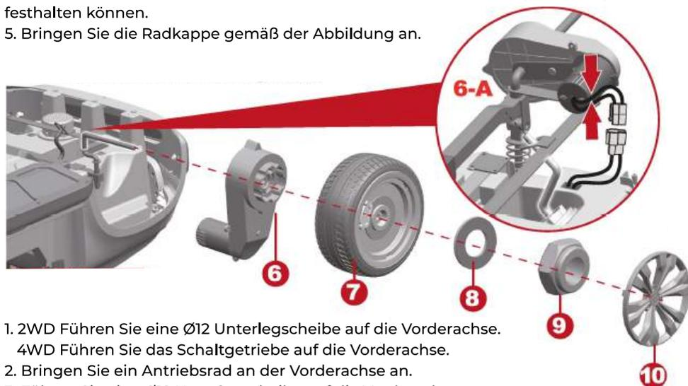
1. 2WD Führen Sie eine  $\varnothing 12$  Unterlegscheibe auf die Vorderachse.
