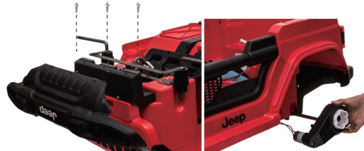
Klicken Sie den Stoßfänger in seine Halterung und befestigen Sie ihn mit den drei Schrauben. Stecken Sie die Motoren auf die Achse und führen Sie die Kabel durch die Löcher. Verbinden Sie die Stecker im Fahrzeug. Wiederholen Sie das auch an der Vorderachse. Achten Sie darauf, die Motoren an der richtigen Seite zu verwenden. (siehe Fotos)
