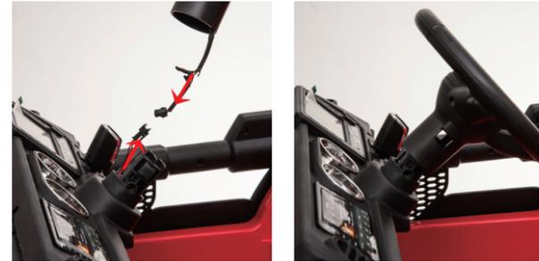
Verbinden Sie die Stecker am Lenkrad. Stecken Sie das Lenkrad auf die Lenkstange. Achten Sie darauf, dass Sie die Kabel nicht abquetschen. Dann stecken Sie die Schraube von der Seite durch und ziehen Sie mit der Mutter fest. Sollte das Loch nicht passen, drücken Sie die Lenkstange unten etwas hoch.
