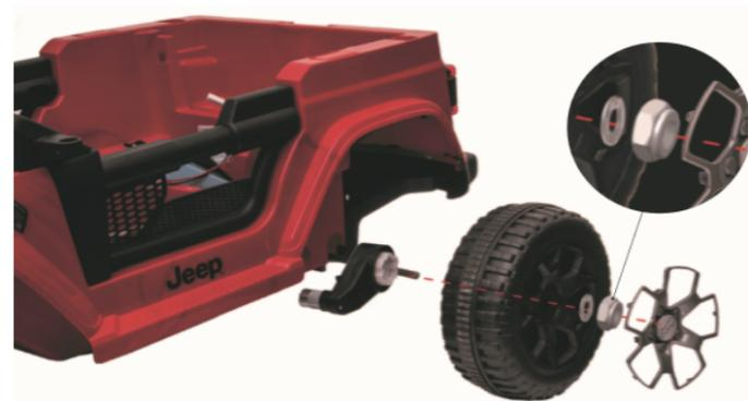
Stecken Sie vorne und hinten die Räder auf die Achsen. dann verwenden Sie die Unterlegscheiben und zum Schluss die Mutter. Gleichen Sie mit den Scheiben das Spiel aus. Die Räder sollen sich nicht horizontal auf der Achse bewegen. Wenn Fett zur Hand, die Achsen vorher etwas einfetten. **Achtung!** Die selbstsichernden Muttern müssen im Falle einer späteren Demontage ersetzt werden.
