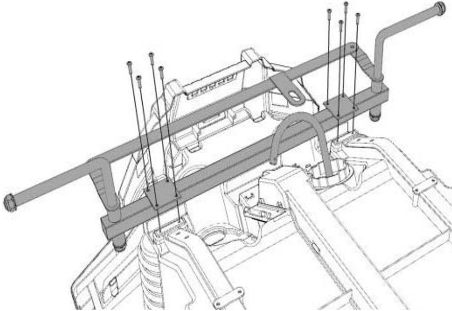
A. Drehen Sie die Lenkstange beiseite. Achten Sie auf richtigen Sitz der Löcher. Befestigen Sie die Vorderachse mit 8 Schrauben.
