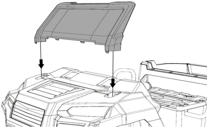
A. Drücken Sie die Frontscheibe rein, und befestigen diese mit 2 Schrauben.
