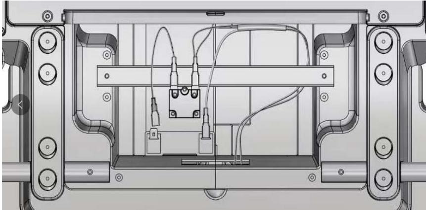
A. Verbinden Sie die Stecker der Batterie. Diese sind farblich gekennzeichnet. Achte Sie auf richtige Polarität. Schliessen Sie die Batterie nicht kurz. Das Batteriefach befindet sich unter dem Sitz
