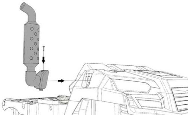
A. Drücken Sie das Abgasrohr in die Öffnung und befestigen es mit einer Schraube.
