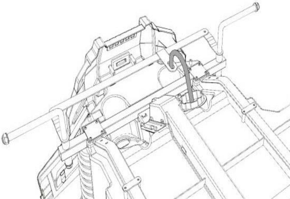
A. Drehen Sie die Lenkstange nach vorne und führen sie in das Langloch ein. Sichern Sie die Lenkstange mit Unterlegscheibe und Splint.
