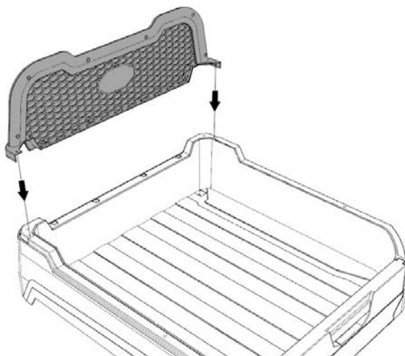
A. Setzen Sie das Windschott vorne auf die Kippermulde und fixieren es mit 4 Schrauben.
