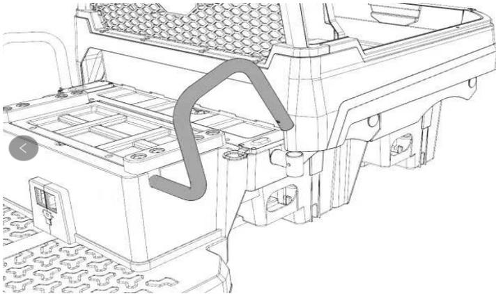
B. Stecken Sie den Sitzbügel an der linken Seite ein und befestigen ihn mit Schrauben.
