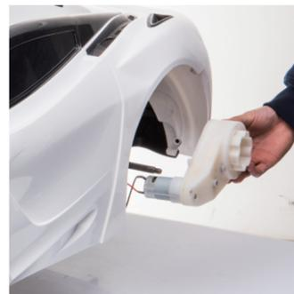
Nehmen Sie die Antriebsmotoren aus dem Auto. Trennen Sie dazu die Steckverbindungen. Stecken Sie die Motoren auf die Achse und führen Sie die Kabel durch die Löcher. Verbinden Sie die Stecker im Fahrzeug. (siehe Foto)
