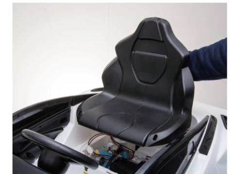
Führen Sie den Sitz vorne in seine Befestigung ein. Drücken Sie ihn hinten herunter, damit er einrastet. Sollten Sie eine Ausführung mit geschraubten Sitz haben, rasten Sie dem Sitz hinten ein und schrauben ihn vorne links und rechts fest.
