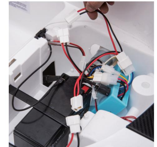
Verbinden Sie den Batterie Stecker, wie auf dem Foto gezeigt. Kontrollieren Sie die anderen Steckverbindungen.
