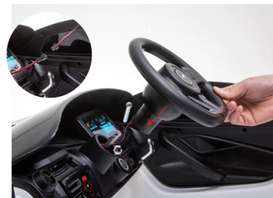
Verbinden Sie die Stecker am Lenkrad. Stecken Sie das Lenkrad auf die Lenkstange. Achten Sie darauf, dass Sie die Kabel nicht abquetschen. Dann stecken Sie die Schraube von der Seite durch und ziehen Sie mit der Mutter fest. Sollte das Loch nicht passen, drücken Sie ggf. die Lenkstange von unten etwas hoch.
